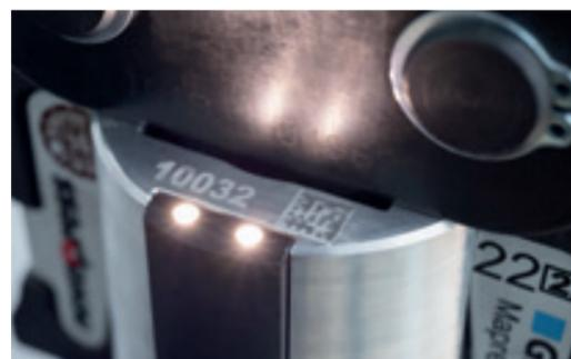
Un éclairage du point de sertissage intégré dans les modèles Geberit ACO 203plus, ECO 203 et ACO 203XLplus garantit une visibilité parfaite dans les coins sombres.
