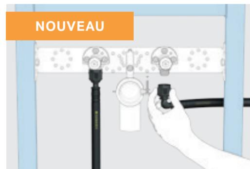
Audible, perceptible, visible : Geberit MasterFix vérifie si l'installation est terminée pour assurer des connexions fiables.
