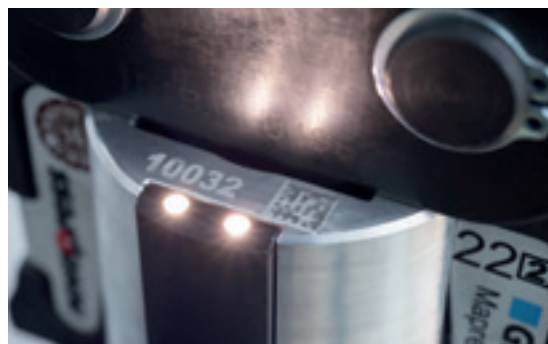
Een geïntegreerd licht in de Geberit ACO 203plus, ECO 203 en ACO 203XLplus zorgt voor een goede zichtbaarheid in donkere hoeken.
