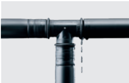
Gedefinieerde lekkagepaden maken niet-geperste fittingen direct zichtbaar in de druktest.
