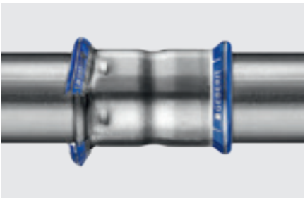
Gekleurde indicatoren identificeren niet-geperste Mapress fittingen zelfs vóór de druktest.
