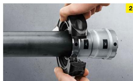
2 Pour le sertissage de raccords Megapress à partir de 1/4 pouce, seuls des anneaux de sertissage dotés d'une mâchoire articulée sont utilisés. Dans de petites dimensions comprises entre 3/8 et 1 pouce, les mâchoires à sertir conviennent tout aussi bien que les anneaux de sertissage avec mâchoire articulée.
