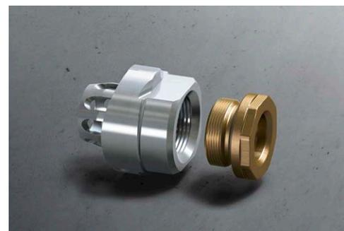
Le raccord à sertissage interne convient pour les tubes en acier selon les normes NBN EN 10255, NBN EN 10220/10216-1 ou NBN EN 10220/10217-1 et il est disponible pour les dimensions de tubes en acier d'1 1/2, 2, 2 1/2, 3, 4, 5 et 6 pouces. Il est équipé d'un filet femelle de Rp 3/4 pouce. Une réduction vers un filet femelle de Rp 1/2 pouce est également disponible.
