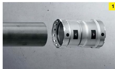
1 Le tube en acier est coupé et nettoyé. Puis la profondeur d'emboîtement est mesurée et marquée. Le raccord Megapress est ensuite poussé sur le tube jusqu'au marquage.
