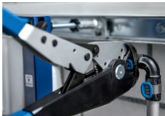
↑ Handperstangen dekken vijf afmetingen en vereisen geen voedingsspanning of oplaadbare batterijen.
