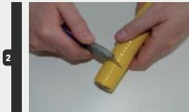
À l'aide d'un couteau à dénuder / de sécurité, découpez le manche jaune à environ 30 mm de l'extrémité de la tubulure. La coupe doit être faite dans la vallée de deux ondulations, en prenant soin de s'assurer qu'une quantité minimale de matériel est enlevée.
