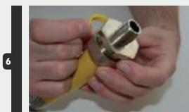
Une fois le tube GFS® complètement inséré dans le raccord GFS®, retirez l'anneau de transport en plastique jaune situé entre l'hexagone du raccord GFS et l'écrou de compression.
