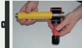
À l'aide d'un outil de coupe de tuyaux, effectuez la coupe requise dans la vallée de deux ondulations du PLT GFS®, en s'assurant que les rotations circulaires complètes sont faites dans la même direction.
